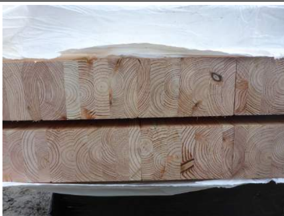
Leimbinder in Lärche
