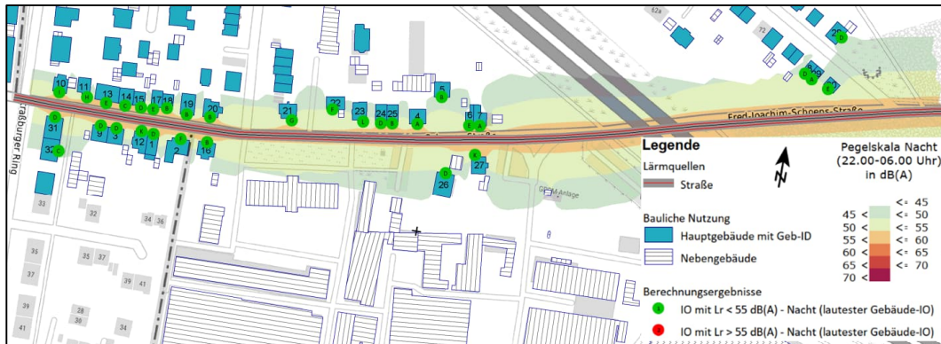
Abbildung 2: Lageplan K 4140 (Geschwindigkeitsreduzierung auf Tempo 30 km/h, Nachtzeitraum)
