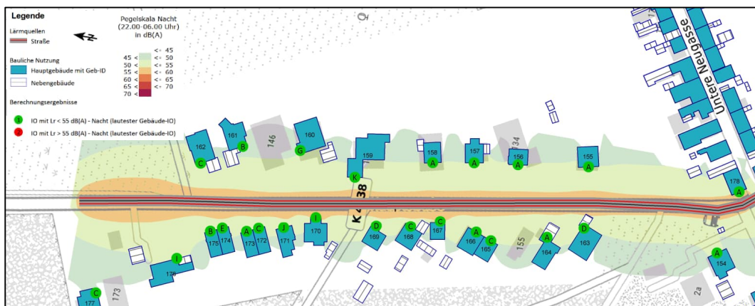
Abbildung 10: Lageplan K 4138 Ortseingang Edingen (Geschwindigkeitsreduzierung auf Tempo 30 km/h, Nachtzeitraum)
